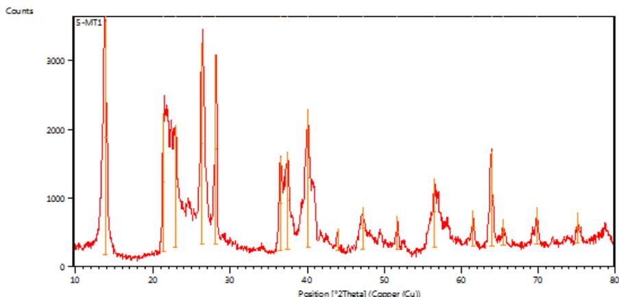
**FIGURE 2** XRD spectrum of kao surface
