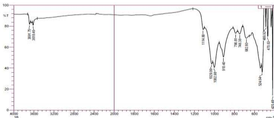
**FIGURE 4** FT-IR spectrum of kao surface
